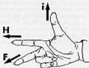
Fig. 1. Règle des 3 doigts de la main droite.
